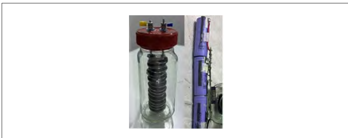
FIGURA 14. Generador de Hidrógeno
