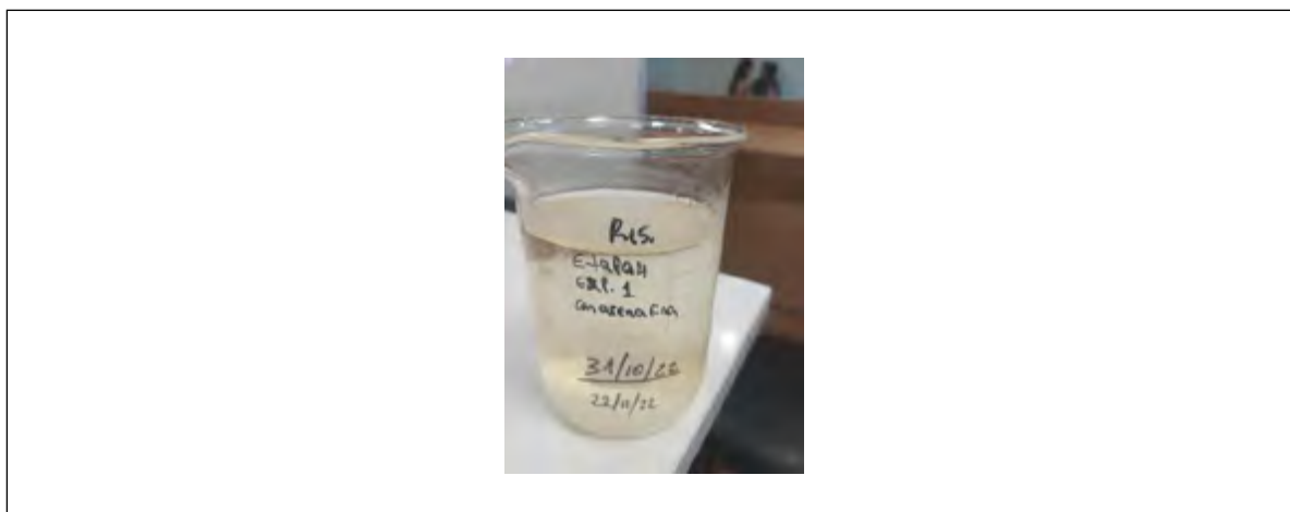
FIGURA 5. 500 ml de efluente + 10 gr de cal hidratada + 10 gr arena fina- 10 minutos de agitación
