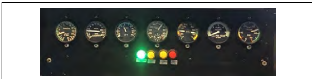
FIGURA 4. Instrumentos de indicación de condiciones del motor, extraídos de la aeronave Piper PA 42-720 y adaptados al interior de la cabina de pruebas.
