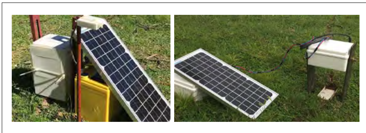
FIGURA 2. Diseño del AntVRecord con dos puntos de apoyo utilizando un soporte físico de fabricación
