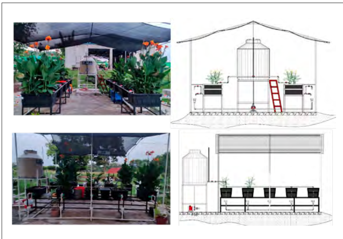
FIGURA 13. Prototipo resultado en etapa de operación en ciclo 1, componentes integrados, nivel TRL 5
