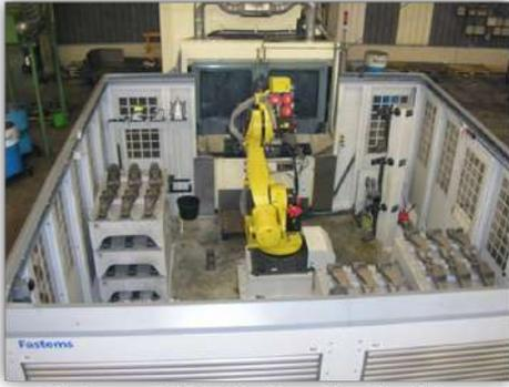
**Sistema FMS: fabricación flexible.**
